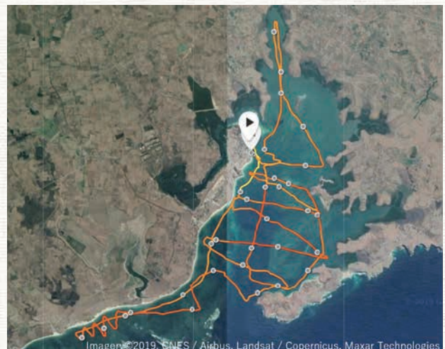
図4 深浅測量のための航行軌跡 (地図データ: Imagery©2019, CNES / Airbus, Landsat / Copernicus, Maxar Technologies)
