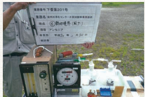
臭気濃度測定状況（アンモニア）
