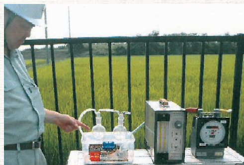
臭気測定(敷地境界アンモニア)
